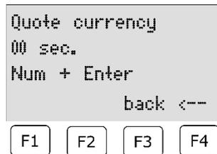
Geben Sie die Zeit, wie lange die Fremdwahrung angezeigt werden soll (00-99s) uber die numerische Tastatur ein, und bestatigen Sie mit der Taste Enter.
