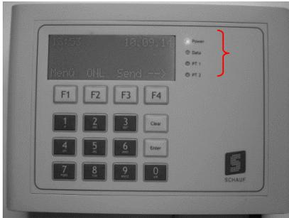
**Power** LED leuchtet blau, wenn das Gerät über ein Steckernetzteil mit Spannung versorgt wird.
